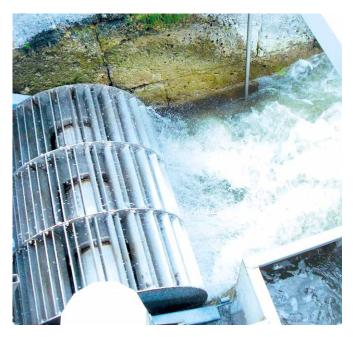
Durch die Anordnung der Lamellen zum eindringenden Wasser sowie der Lamellen zueinander kann die individuelle Situation aus Fallhöhe und Durchsatz optimal berücksichtigt und so ein hoher Wirkungsgrad erreicht werden. Durch die Teilung und die nach innen offene Ausführung kann das Wasser am Ende des Durchlaufs ohne Widerstand aus dem Rad ins Unterwasser abfließen, indem es das Rad wieder an der Außenseite verlässt.
